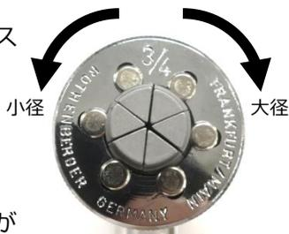
破損する可能性があります。小径から徐々に大径に変更し調整してください。
