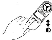
3. 計測モードを選択してください。右矢印ボタン (▶) を押すと、下記の計測項目がスクロールできます。左矢印ボタン (◀) を押すと、逆順でスクロールできます。その場の計測値が表示されます。(詳しくは「計測項目の説明」をご覧ください。)
