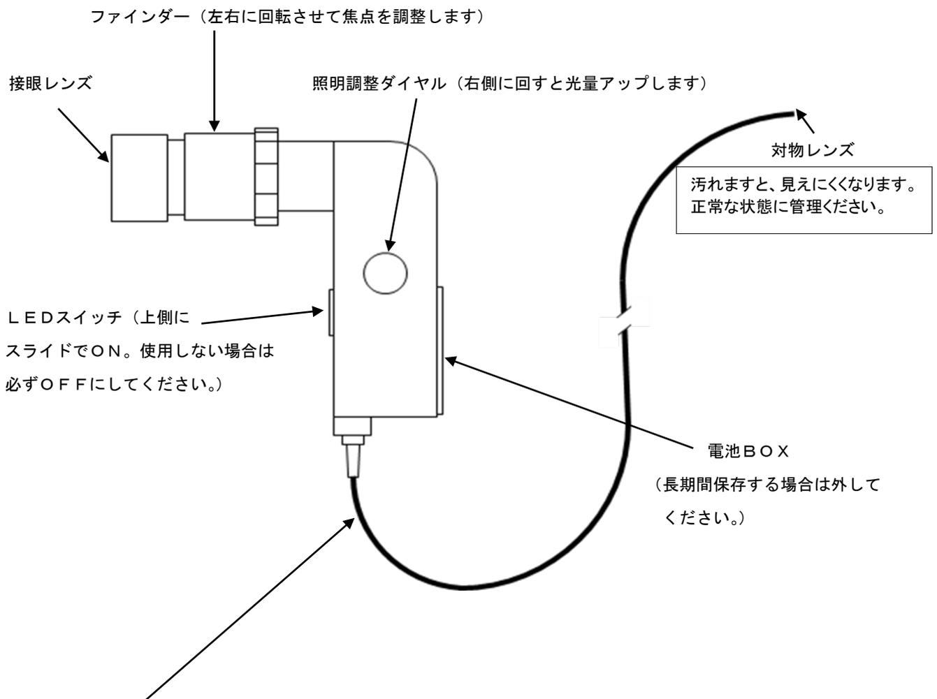
ファイバーケーブル（φ3mm×80cm）・・・画像を伝達するファイバーケーブルです。ファイバーケーブルは強く曲げたり、同じ場所を何度も曲げないように注意してください。また直径8cm以下に丸めたり、鋭角や直角に曲げないでください。（折損の恐れがあります）
