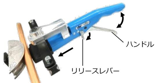
6. 希望の角度まで銅管が曲がったら、リリースレバーを図の方向に倒すと、シューが後退しますので銅管を外して下さい。
