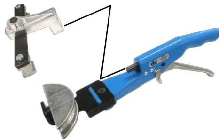
5. 銅管をセットして、リリースレバーを図の方向に倒し、ハンドルを繰り返し握ると、シューが前進し銅管の曲げ加工が始まります。
